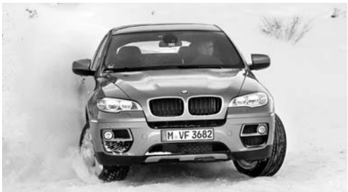
가변식 사륜구동 시스템인 x드라이브가 기본 장착된 BMW의 SUV ‘X시리즈’
